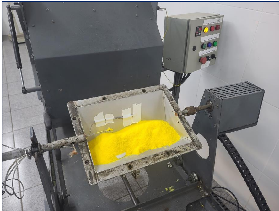
MOLDE COM PE BRASKEM ML3602U
